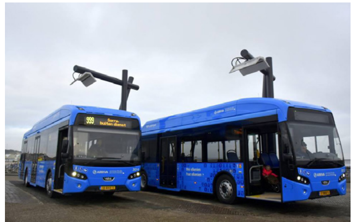
Foto: Elektrische bussen en laadpalen
